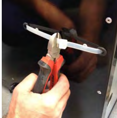
Bilder 2: Um den Kabelbinder zu schneiden, bitte benutzen Sie eine Zange oder andere entsprechende Werkzeug.
