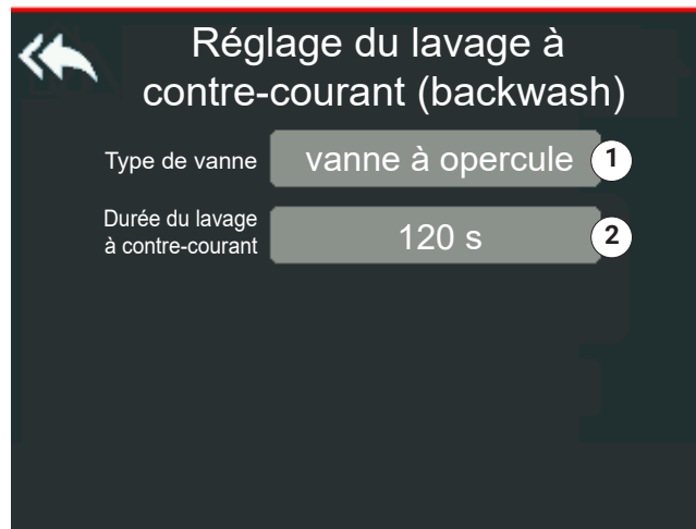
Figure 4 : Programmation du lavage à contre-courant
